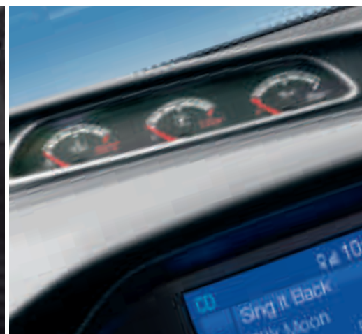
Оригинальный блок приборов ST В блоке приборов объединены указатели давления турбонаддува, давления масла и температуры масла.
